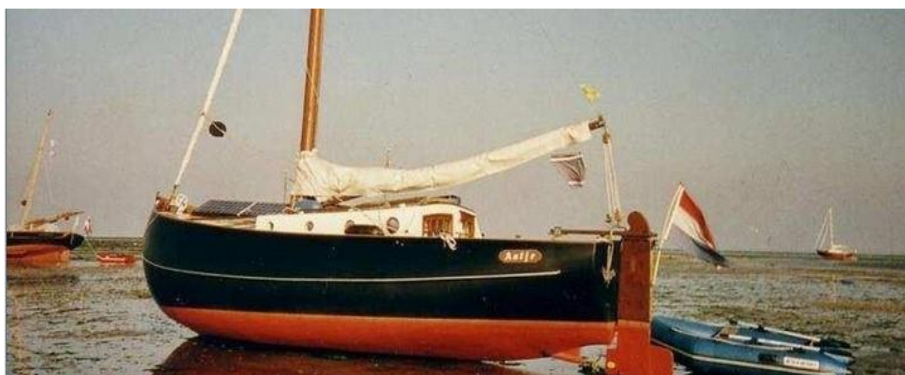
Goed te zien is onder aan het voorstag het wielkje waarmee de rolfok wordt gespannen.
