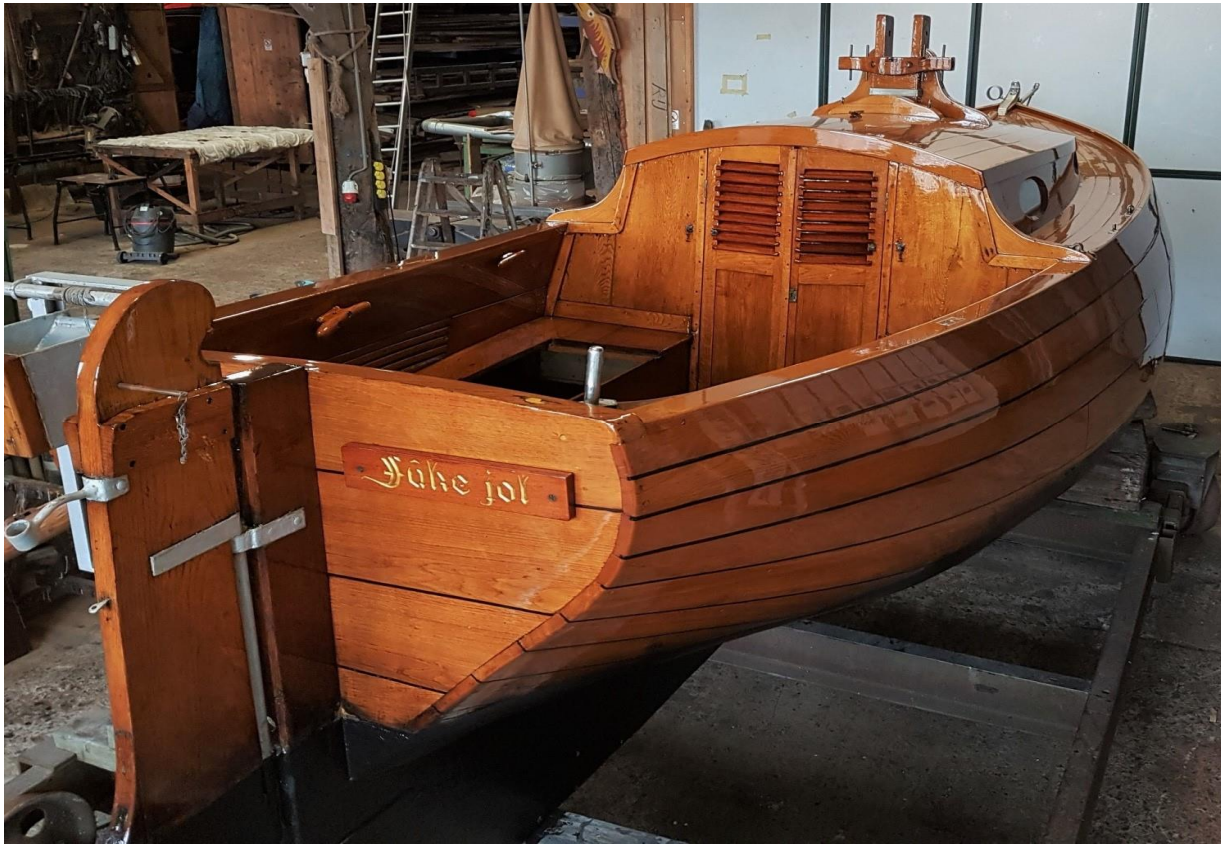
Sneek, okt. 2016. De ST 43 met de toepasselijke naam 'Fûkejol' in onderhoud op de werf van Job. van der Meulen. De jol was te rank. Daarom heeft J. Wassenaar 250 kg. lood ballast in de kiel laten zetten.
