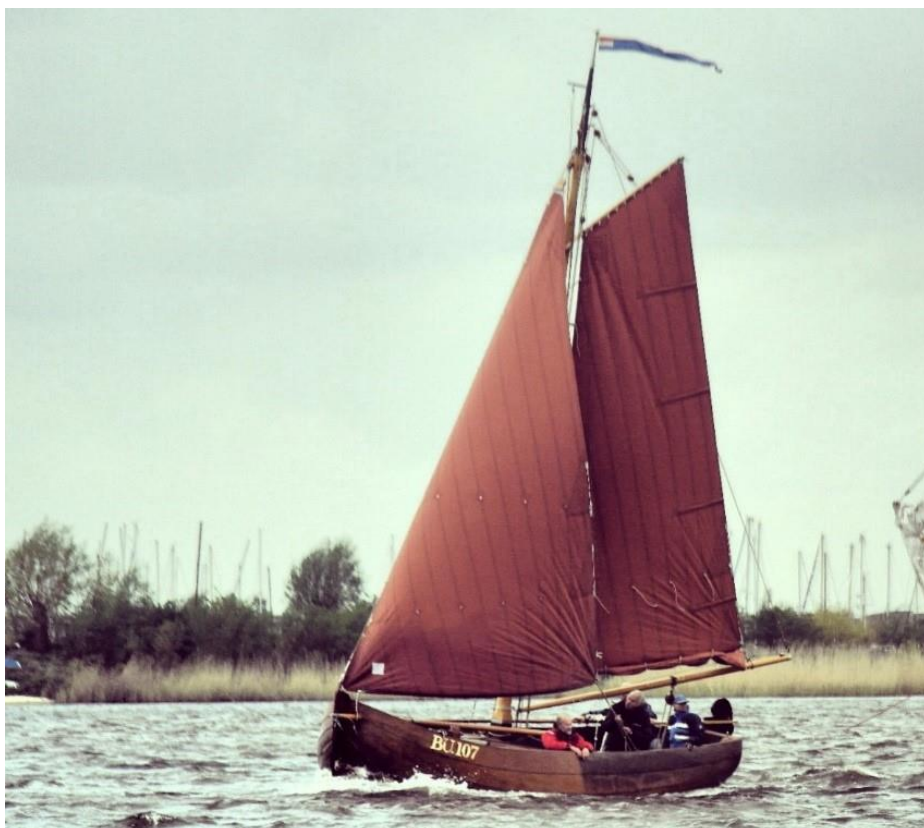
De BU 107, evenals de UK 117 een jol die geleverd is als snijpakket en in elkaar is gelast in Kampen bij De Jongh (Bramcometaal) De BU 107 in opdracht van Harry Ros, die eerder zeilde in een Lemsteraak.
