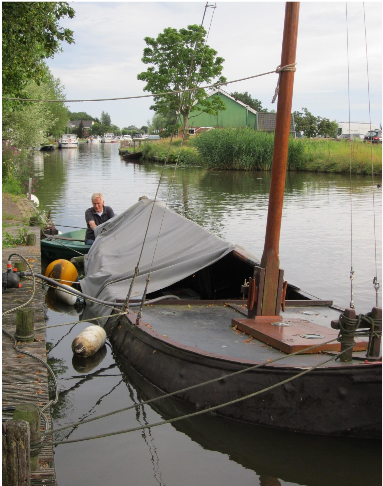
Warga, 2015. De Henke is gezonken, nadat de jol schade opliep door een voorbij varende sleepboot. Na bijna 40 jaren is het houten binnenwerk er niet beter op geworden. De dunne polyester schil om het schip biedt te weinig stevigheid tegen zware belasting. De jol staat sindsdien op de kant. (Foto: W. Tasseron)
