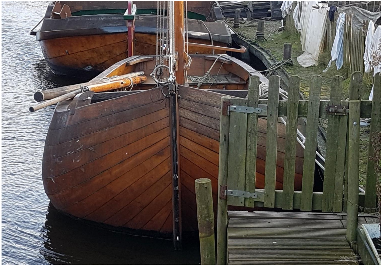
Workum, 2016. De ST 79 voor de kant bij scheepswerf De Hoop. Boven: het fraai verloop van de gangen in de kop. Onder: het forse potdek en de aansluiting bij de voorstevan. (Foto's: Dirk Huijzinga)
