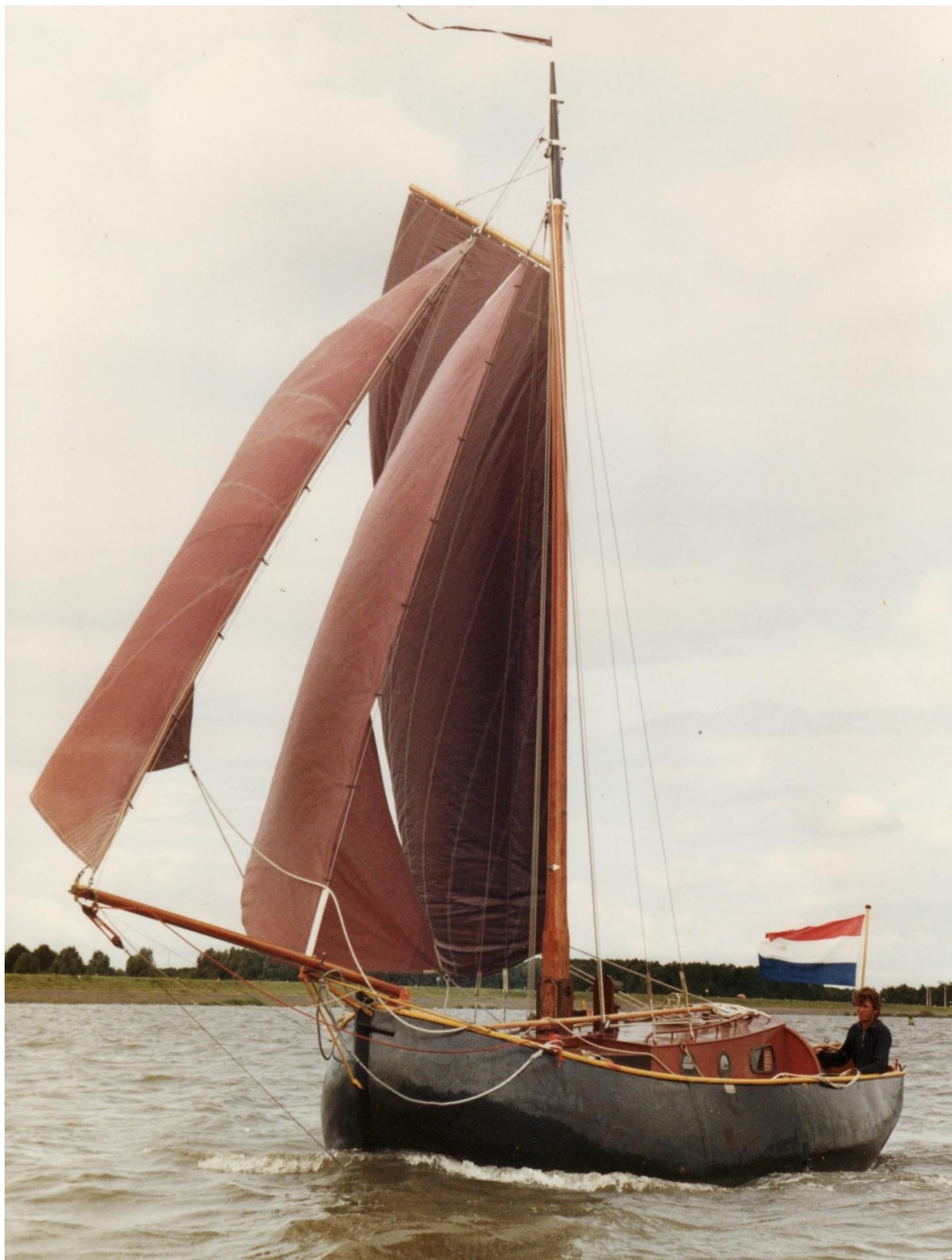
Veluwemeer, 1986. De in 1976 verlengde Volharding met een groter dacron tuig. Lengte 6.50 meter, breedte 2.50 en 30 m 2 zeil. Vaste kluiverboom van 3 meter lang. (Foto: Dirk Huijzinga)
