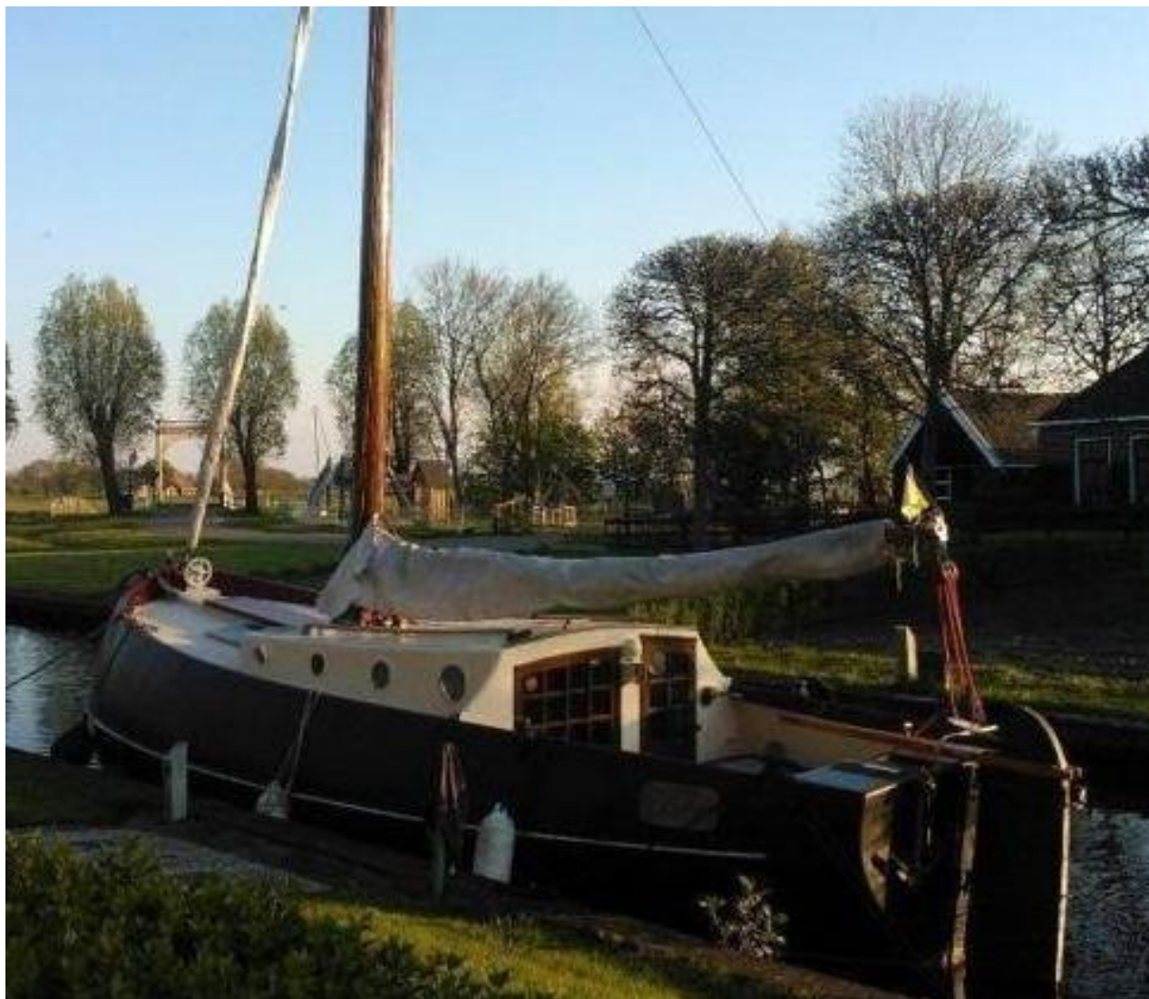
Goed te zien is onder aan het voorstag het wielkje waarmee de rolfok wordt gespannen.
