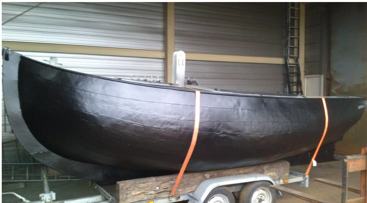
De ST 37 gestraald en in de epoxycoating, klaar om afgebouwd te worden in 2013.
