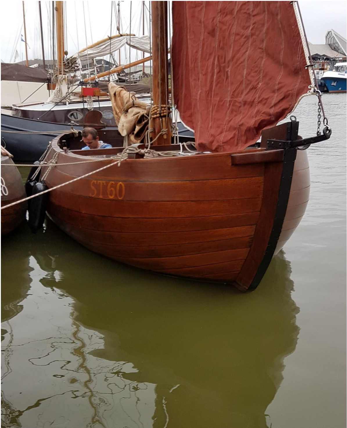
Stavoren, 2016. De ST 60 met de kenmerkende Roosjenkop. Wat opvalt is het wat horizontale verloop van de gangen. Wellicht ontstaan door diverse restauraties in de loop der jaren. Als de gangen meer verjongen naar de steven, ontstaat er een fraaier verloop. (Foto: Dirk Huijzinga)
