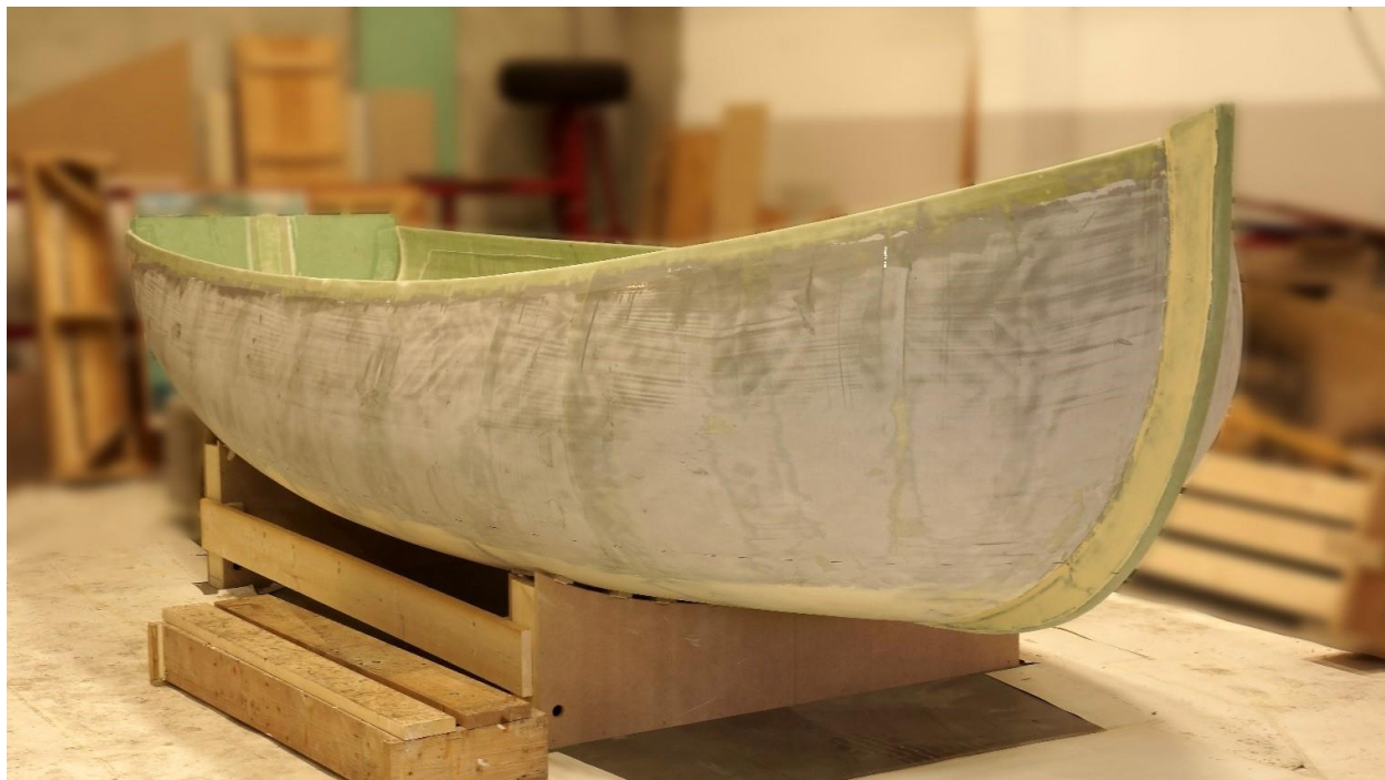
De foam/epoxy Staverse jol Brandaan van Frank Kooper, in aanbouw te Wormerveer. 2016
