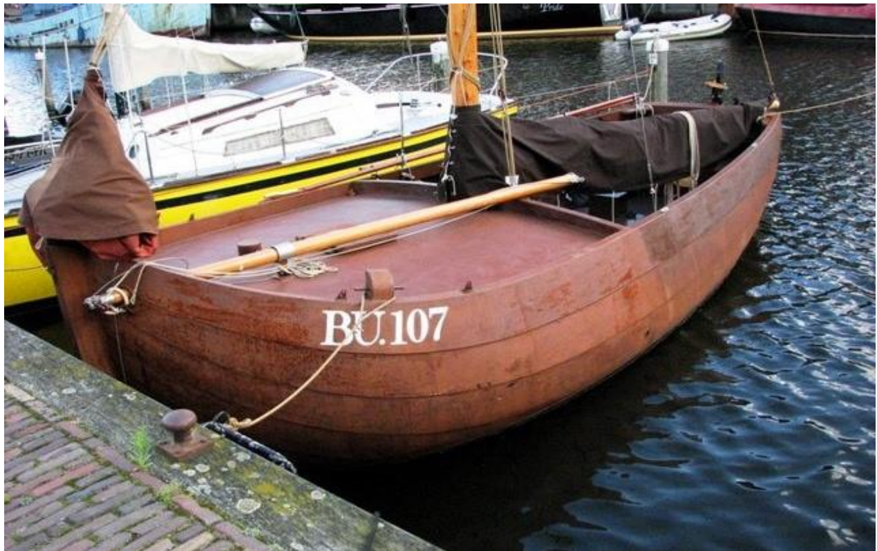
De BU 107, evenals de UK 117 een jol die geleverd is als snijpakket en in elkaar is gelast in Kampen bij De Jongh (Bramcometaal) De BU 107 in opdracht van Harry Ros, die eerder zeilde in een Lemsteraak.
