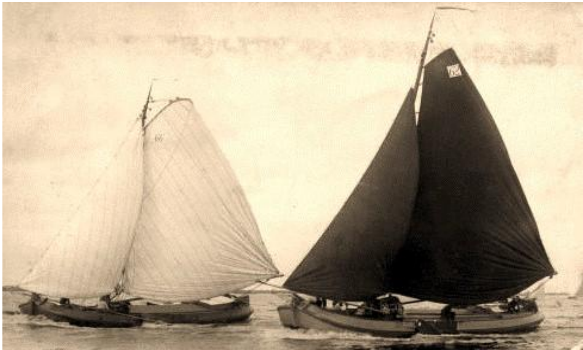
Het linker skûtsje met een nieuw tuig, dat nog niet getaand is. Het rechter met het zogenaamde 'Drents tuig' met een kort vrij recht gaffeltje. Vaak was een Fries tuig te duur voor de schipper.
