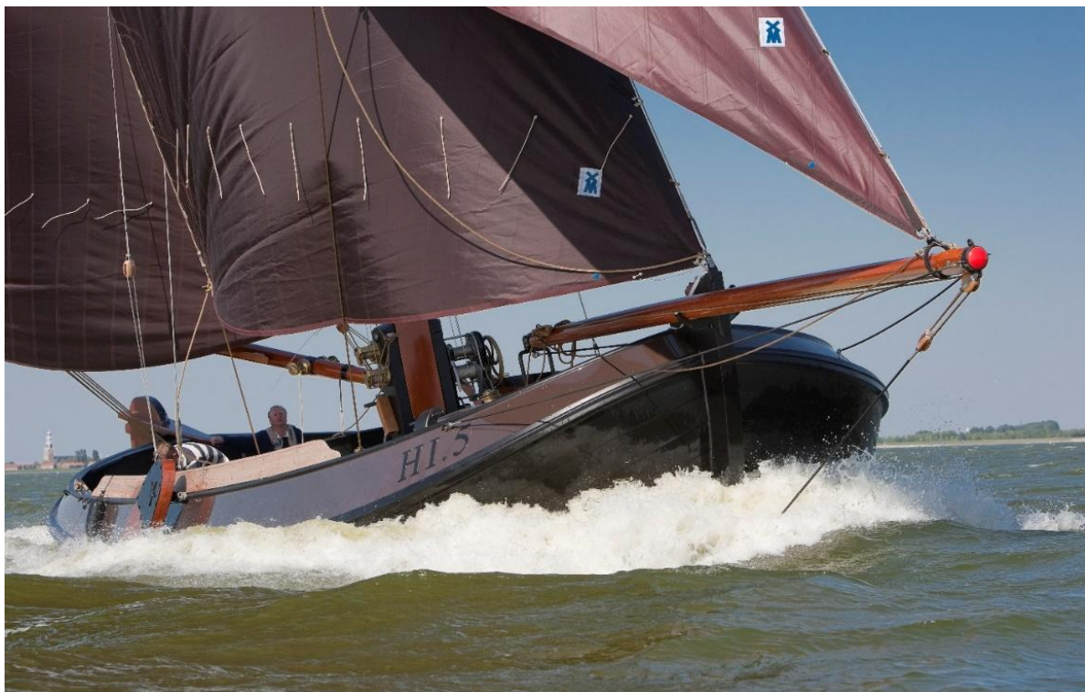
Lemsteraakjacht 'De Warber', 15.50 meter lang en ontworpen door Van Oossanen Naval Architects, die ook de snelle aken Buikschiiver 1 en 2 hebben ontworpen. Het casco is in 2010 gebouwd bij Blom in Hindeloopen.
