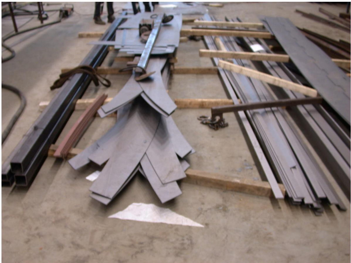
Een snijpakket met voorgevormde onderdelen voor een aluminium jachtje
