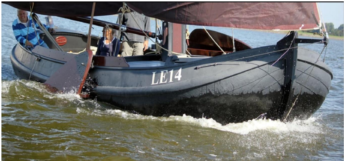
Deze aakjes werden gebouwd voor de visserij op het binnenwater. Vaak ook als onderkomen voor de visser die daarnaast nog een 'boatsje' gebruikte om de fuiken te lichten. Het visaakje was voorzien van een bun waar de gevangen vis levend in bewaard werd. Veel visaakjes hadden een opklapbaar voordek waar de visser een onderkomen had.
