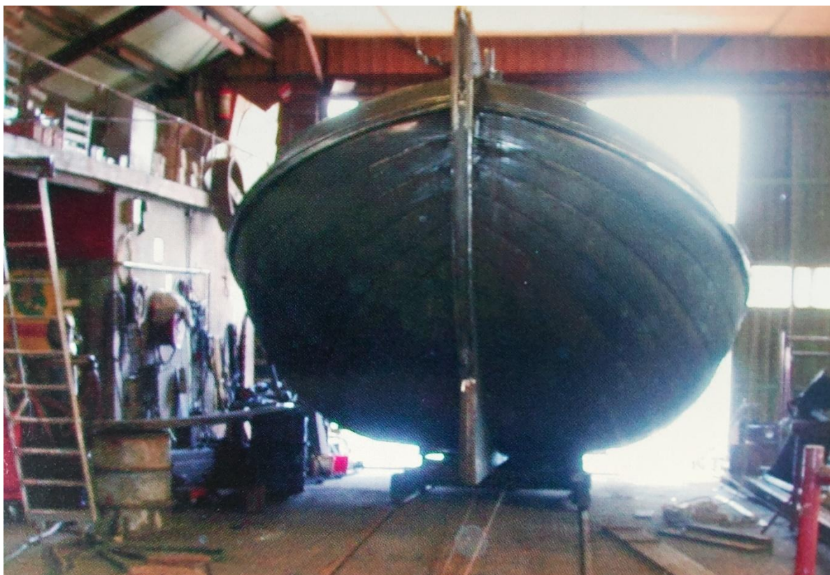
Een aak in aanbouw aan de Westerzeedijk. De vierde gang als sluitgang. (Uit: Fotoboek pensionering Jacob Jongstra)
