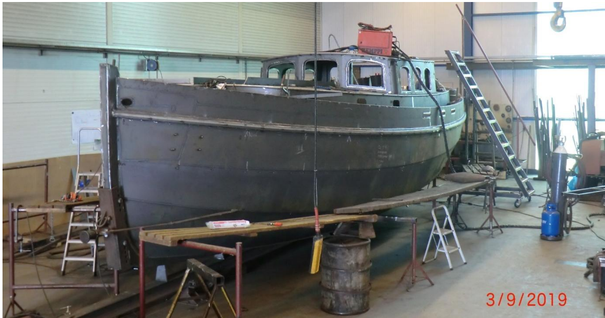
Het casco van een Noordkaper 35, ontwerp Martin Bekebrede Yacht Design, in aanbouw bij scheepswerf Blom.
