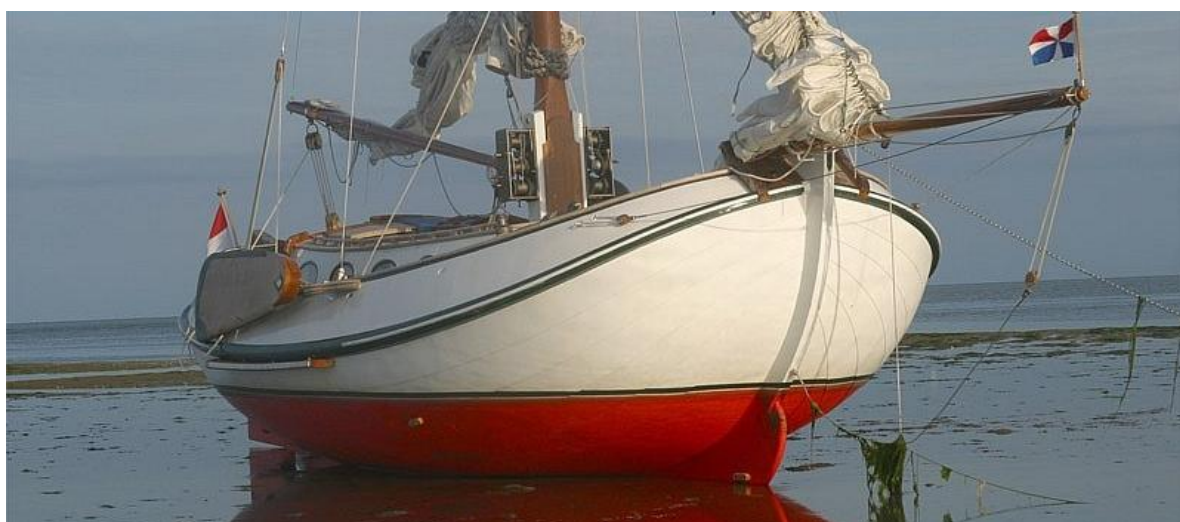
Een 10-meter Blomaakje op het wad. Kenmerkend is o.m. het ontbreken van slemphouten onder de kluisborden. “Slemphouten horen niet op een Lemsteraak”, volgens Dirk Blom Sr. Die verbindingen zijn nodig bij houten aken, maar overbodig bij stalen.
