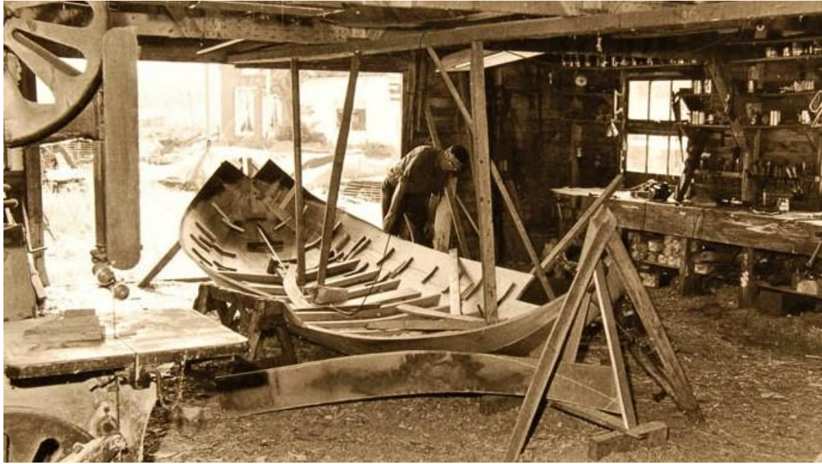
De traditionele houten scheepsbouw, waarbij eerst de huid wordt opgebouwd en de inbouden daarna worden aangebracht, de huidgangen volgend. (Foto: De Jong, Heeg, 1970)
