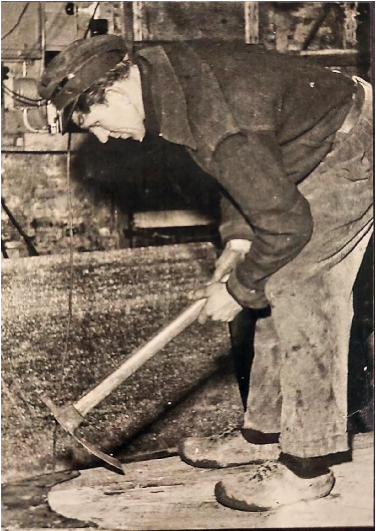
Iege bewerkt een zwaard met de dissel, een dwarsgeplaatste bijl. De dissel was een veelgebruikt gereedschap op scheepswerven rond de Zuiderzee.
