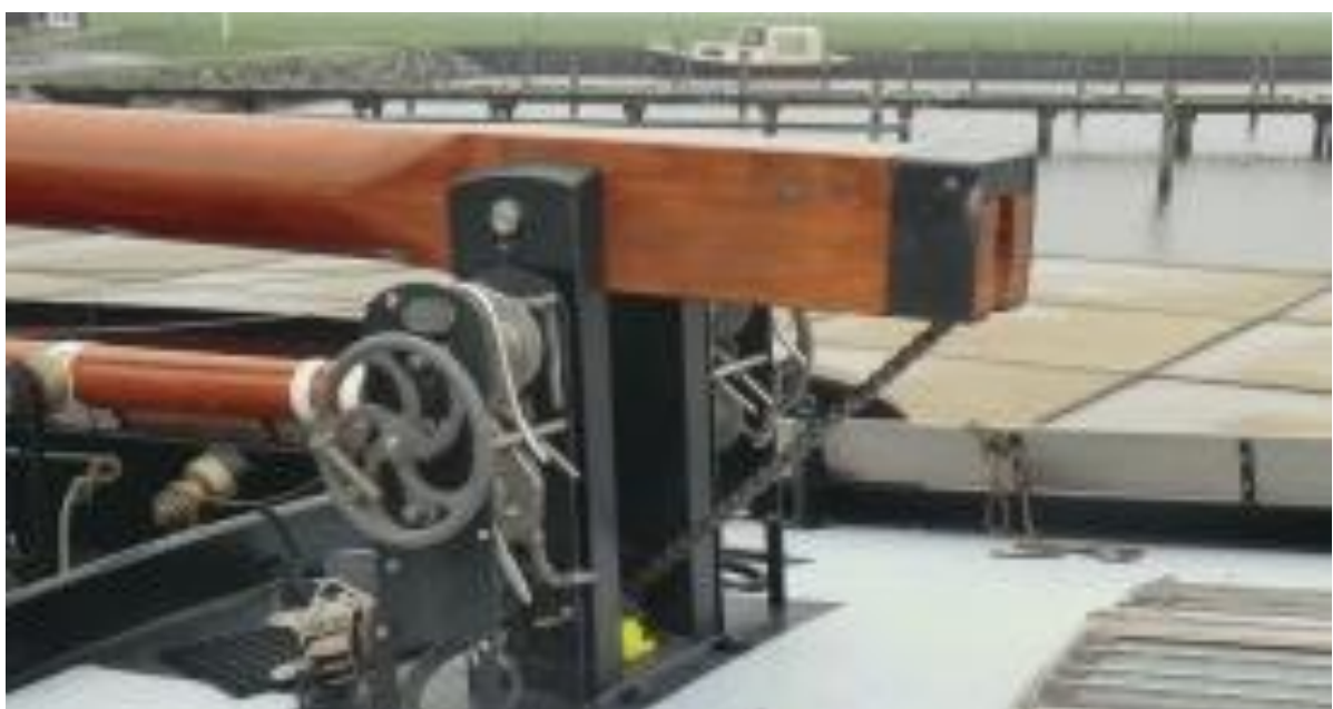
Hydraulische maststrijkinrichting op de Douniege Moei met ketting aan versterkte mastvoet.
