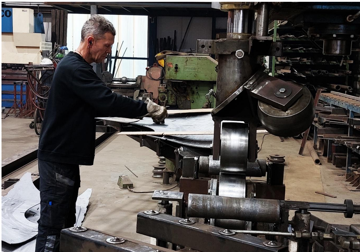
Walsen op aangetekende plekken en met behulp van hardboard mallen voor de juiste bolling.
