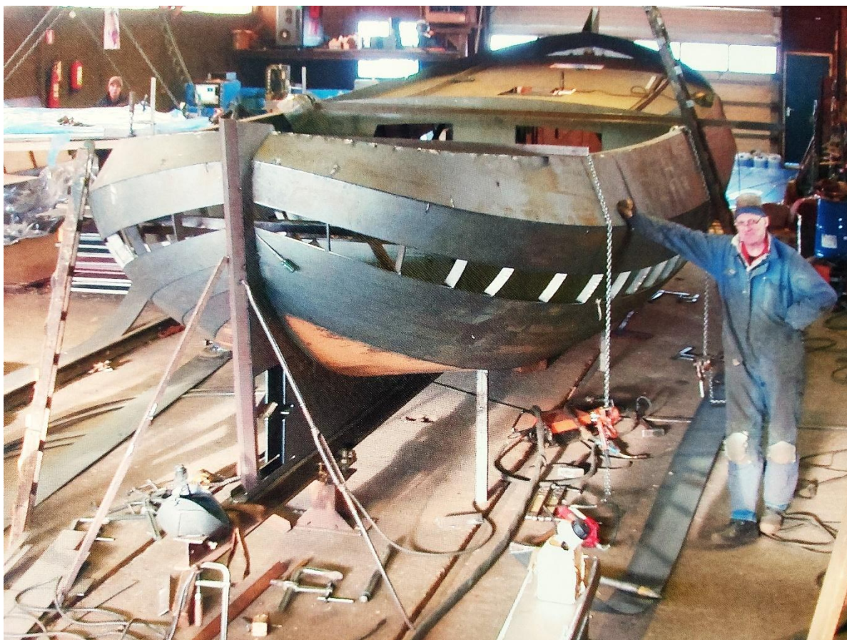
Een aak in aanbouw aan de Westerzeedijk. De vierde gang als sluitgang. (Uit: Fotoboek pensionering Jacob Jongstra)
