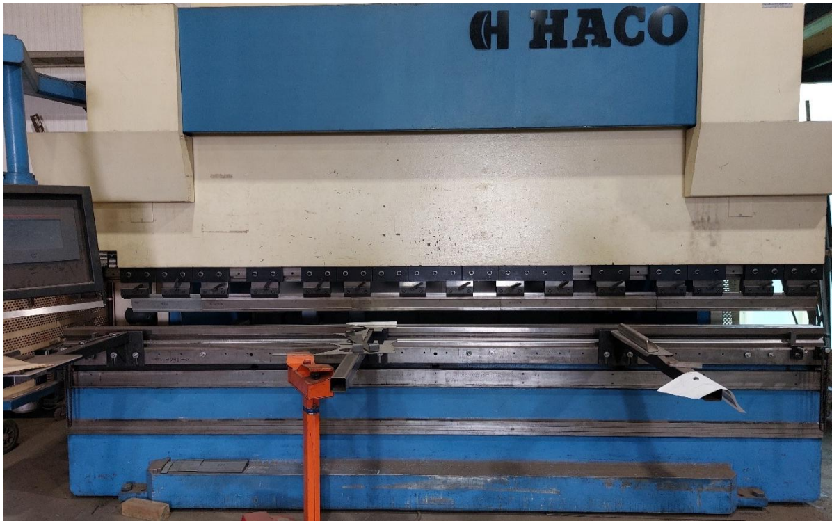
Computergestuurde zetbank om stalen elementen door toepassing van specifieke mallen bepaalde vormen of hoeken mee te geven zoals beschreven in het snijpakket.
