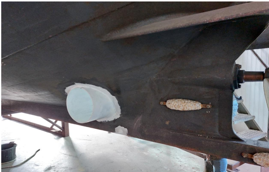
Hindeloopen, 2025. Constructie voor inbouw van een hekschroef bij een Lemsteraak bij Blom.
