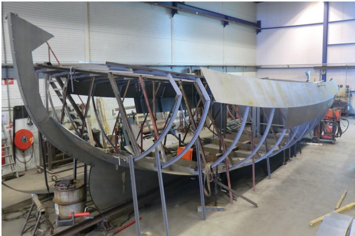
Bouw van een grote Lemsteraak bij Blom. Bij staalbouw wordt gewerkt 'vanaf tekening', wat tegenwoordig een digitaal ontwerp met behulp van een computerprogramma is. Het essentiële verschil met de traditionele houtbouw is, dat bij staalbouw de huid om de spanten wordt aangebracht en dus niet de spanten binnen de aangebrachte huidgangen.
