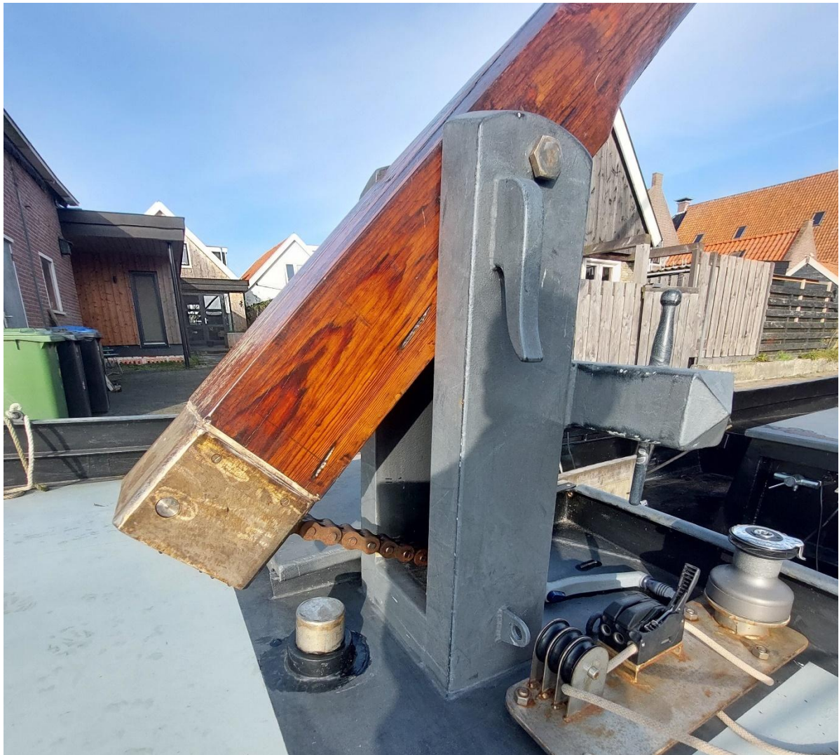
Hydraulische maststrijkinrichting op de Douniege Moei met ketting aan versterkte mastvoet.
