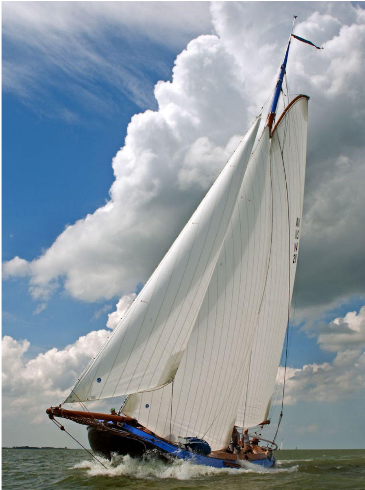
De wedstrijdvaart Buikschiiver 2, 15,25 meter lang. Ontwerp Van Oossanen Naval Architects te Wageningen. Casco gebouwd bij Blom, Hindeloopen. Afgebouwd bij de Workumer Jachtservice., 2012. Oppervlak grootzeil 80 m 2 , botterfok 52 m 2 , kluiver 24 m 2 . (Foto: Hajo Olij)
