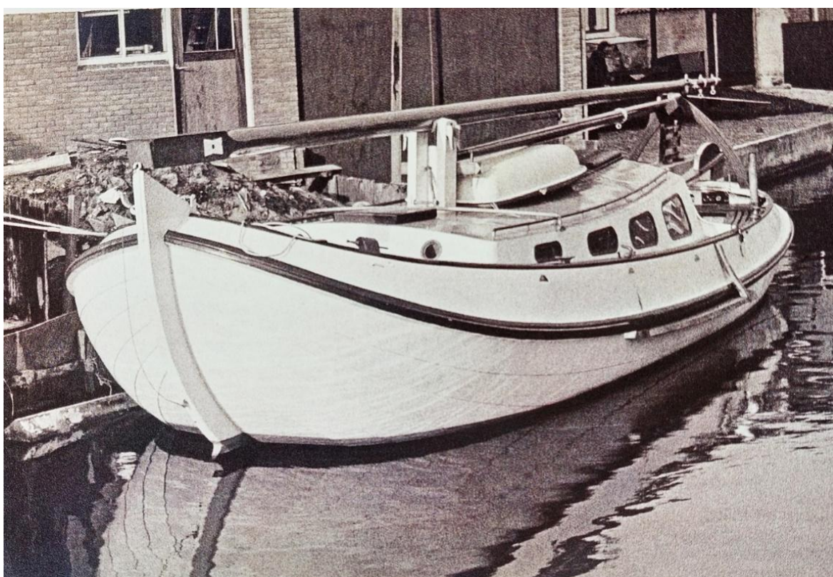
De 10-meter aak voor kunstenaar Jaap Mooij. Nieuw is de doorlopende roef met de mast op het roefdak. Een constructie die in hout nooit werd gedaan, maar in staal goed mogelijk was.
