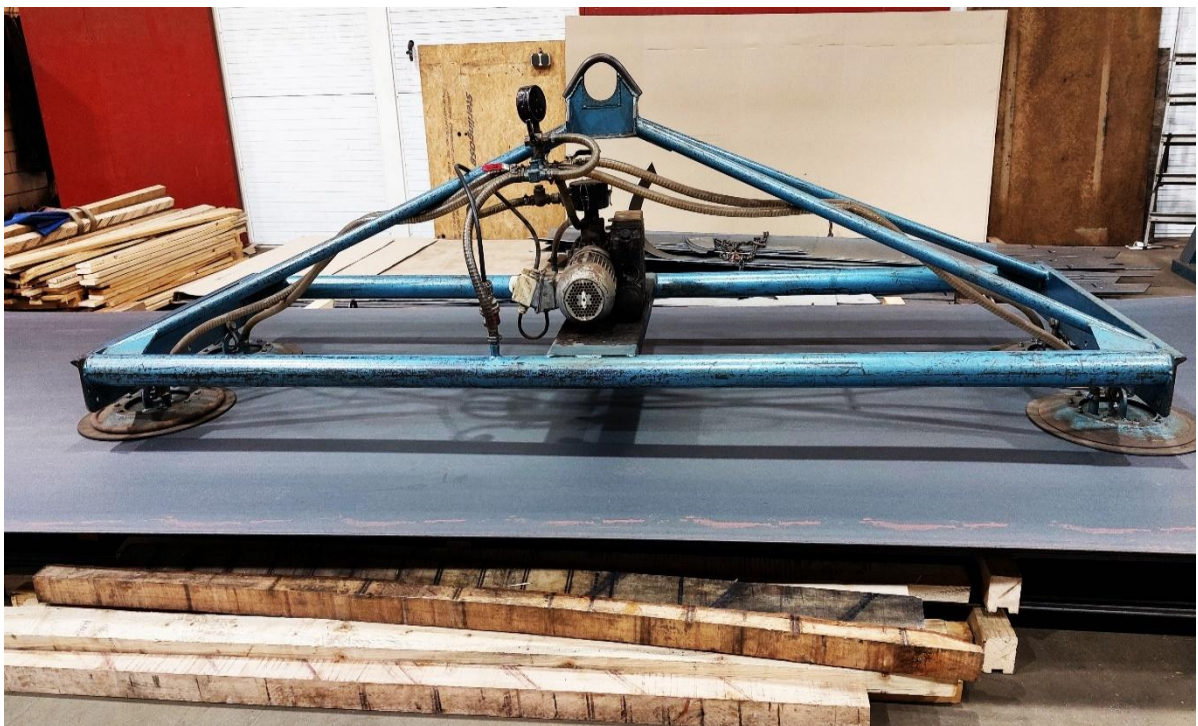
Hulpmiddel om zware staalplaten te verplaatsen
