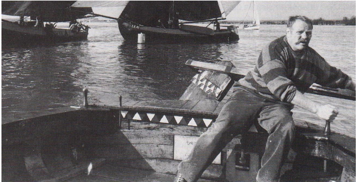
Sturen met het helmbout op een botter tart alle rationele technologie. Op de achtergrond de Lemsteraak LE 41. Ook daar zie je dat de iets schuinstaande achtersteven ertoe leidt dat het roer omhoog moet worden gedraaid. Zo'n stand is allesbehalve effectief en remt vooral af.
