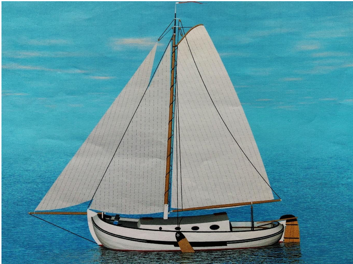
Aak van 10.00 meter. Breedte 3.90 Diepgang 0.70 mtr. Zeiloppervlak 55.5 m 2
