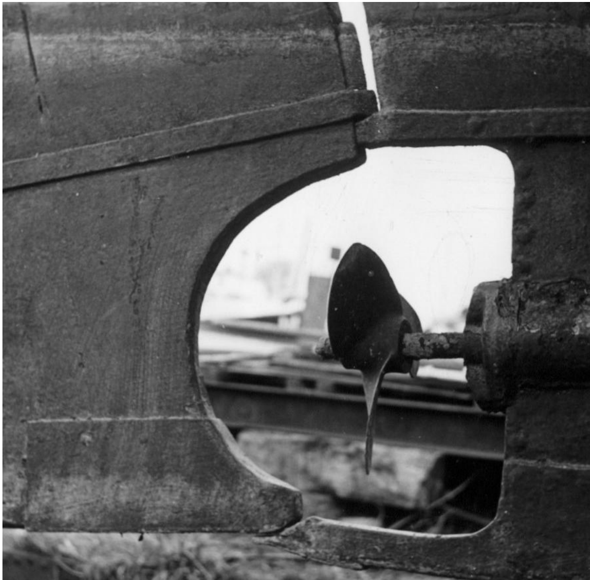
De Lemsteraak LE 12 had blijkbaar te weinig ruimte voor een schroefraam in de scheg. Er is daarom een halffrond uit het roerblad gehaald, met desastreuze gevolgen voor de bestuurbaarheid.
