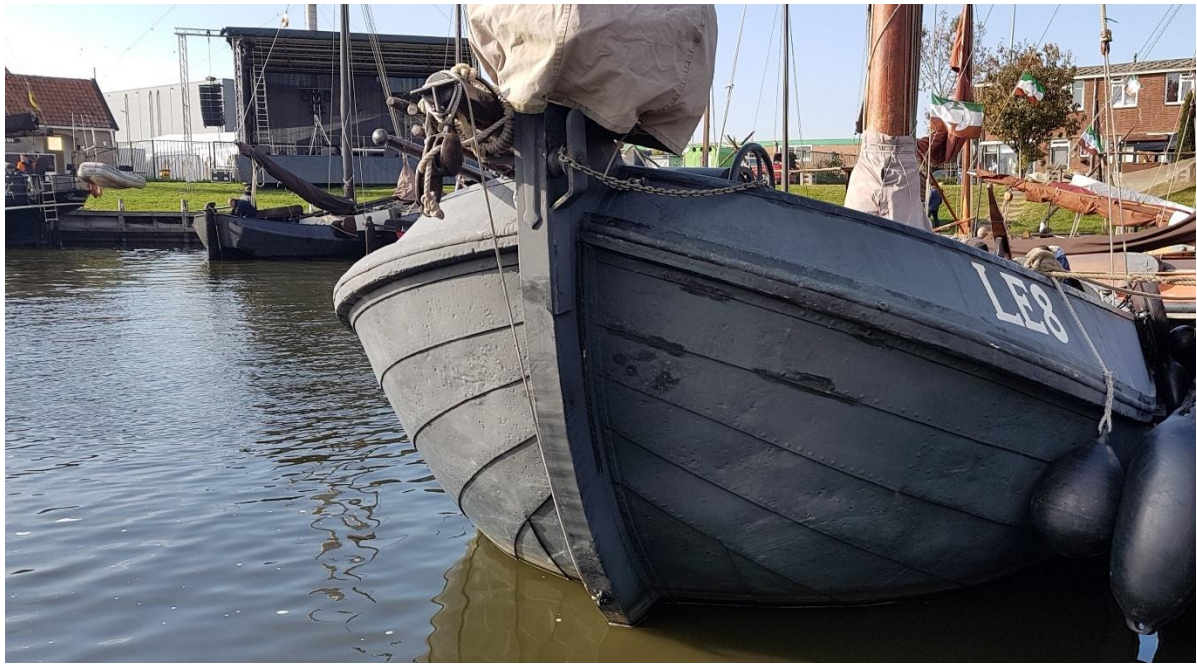
Workum, 2018. De visaak LE 8, gebouwd bij de gebr. De Boer, met een sterk geveegde kop. De waterlijn is veel smaller dan het berghout. (Foto: Dirk Huijzinga)
