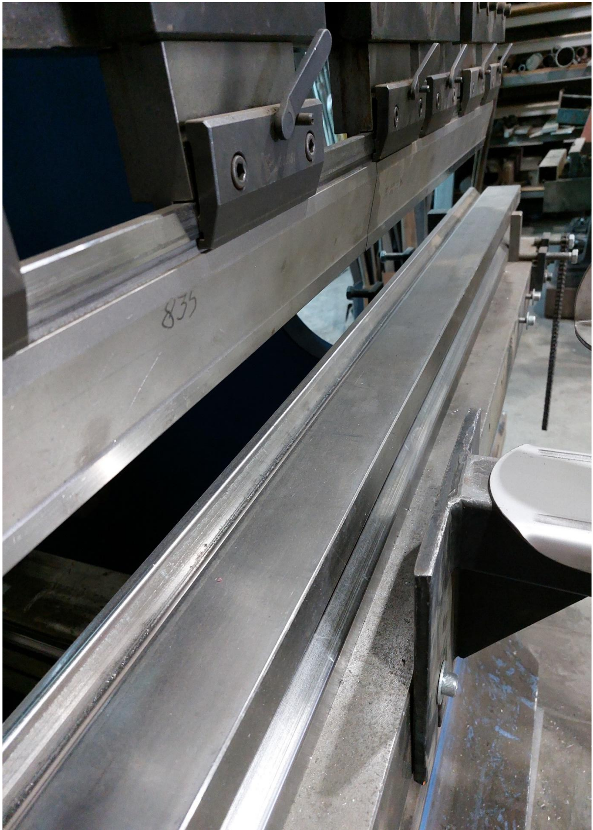
De zetbank met tussen de pers boven en onder de (verwisselbare) mallen die het staal tijdens het persen in de gewenste vorm brengen. (Foto: DH)
