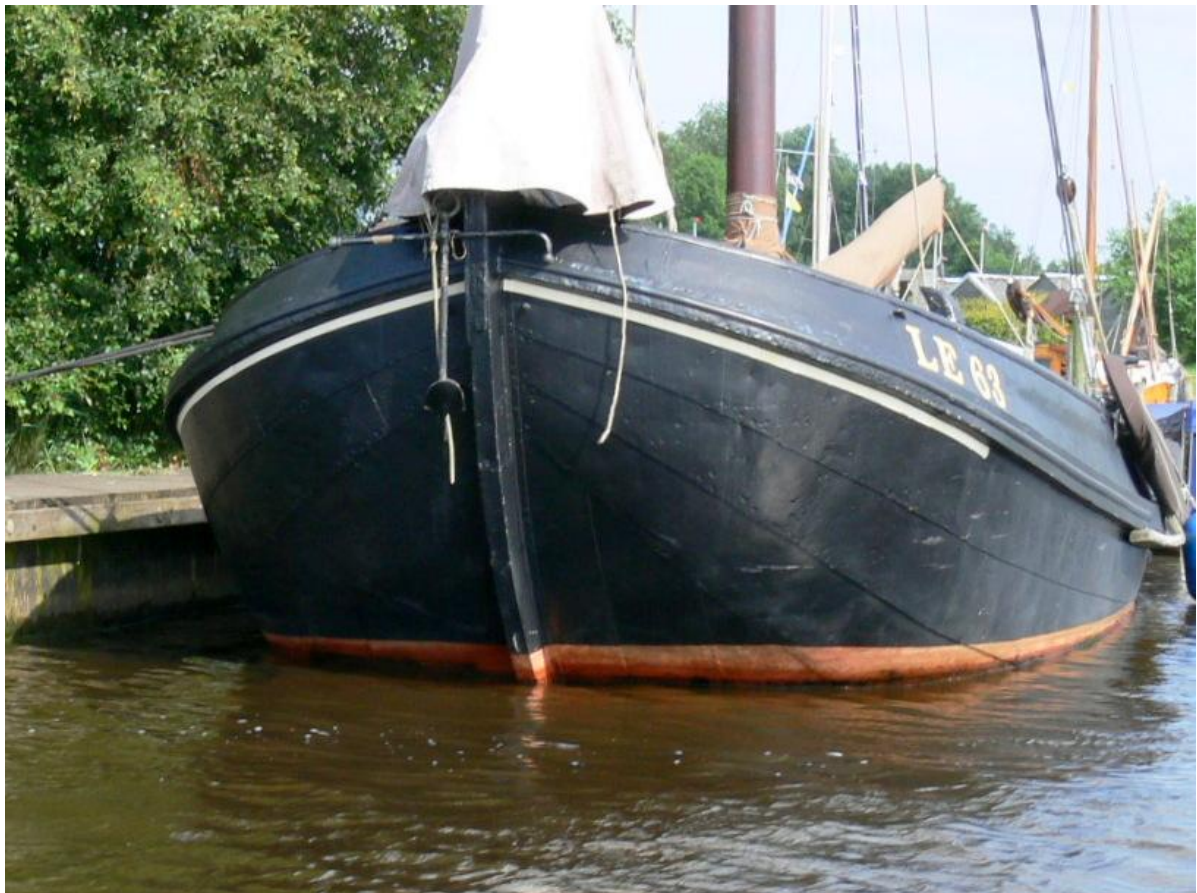
De Veenhoop, 2013. De LE 63 gebouwd door Auke van der Zee, met een stompe kop van ook nog eens slechts drie gangen. (Foto: Dirk Huijzinga)
