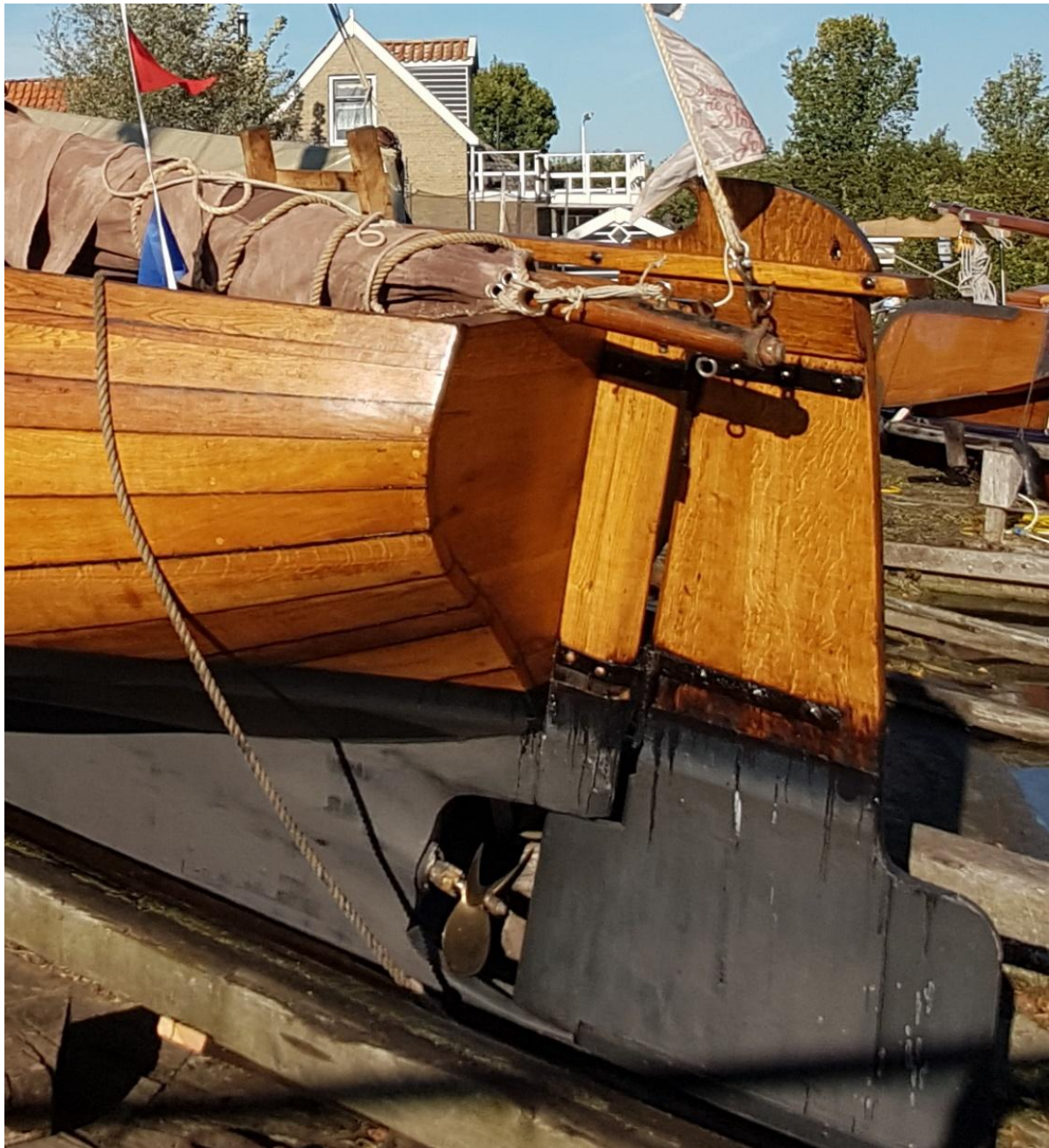
De Staverse jol HL 90, die in 2016 in Workum werd gerestaureerd door Ivor van Klink. Die voorzag het roerblad daarbij van een 'balans', waardoor de jol beter stuurt.. (Foto: DH)
