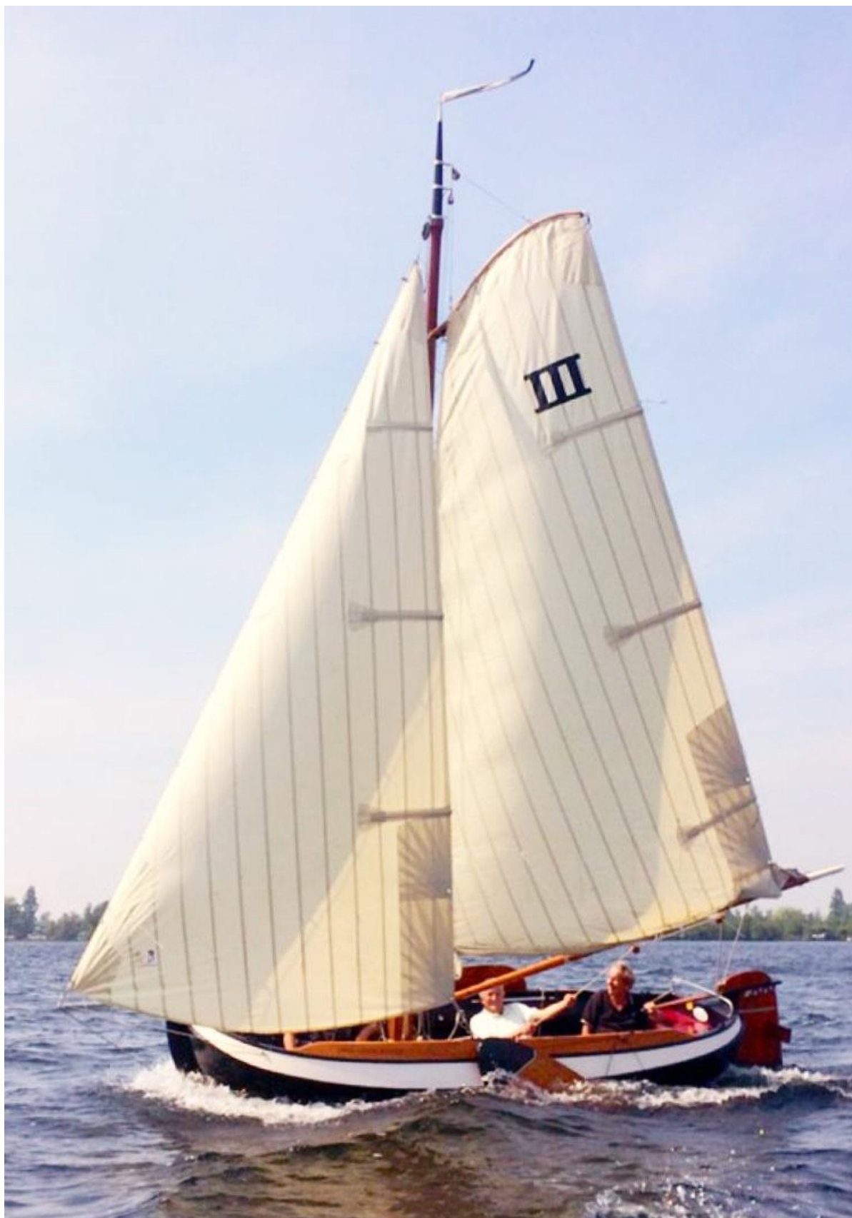
De Blom tjoetter onder zeil. Lengte 4.85 m. en 1.90 meter breed, gebouwd zonder spanten.
