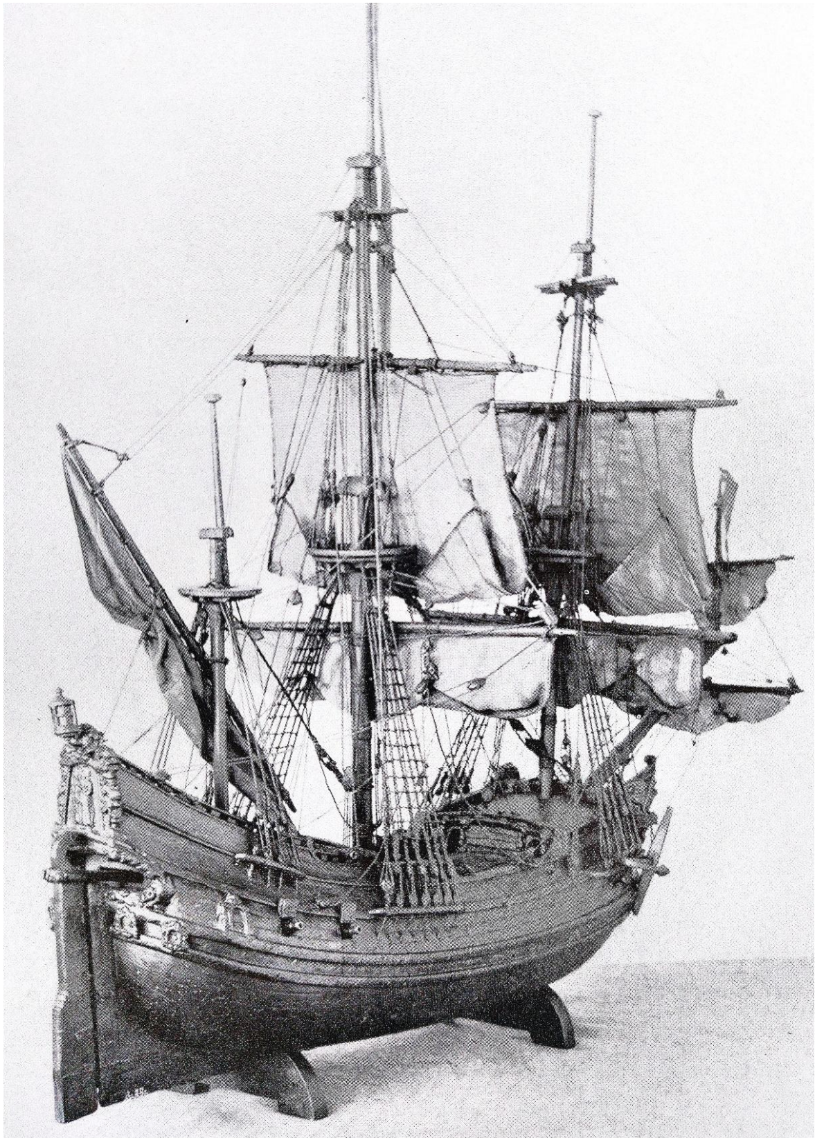
Het bekendste scheepstype van de 17 e eeuw: de fluit, die vooral gebruikt werd voor de Sontvaart. Opmerkelijk voor die tijd is de ronde kont (i.p.v. de platte spiegel van de Oost-Indiëvaarders) en de sterk naar binnen vallende boorden, wellicht omdat bij de tolheffing in de Sont de breedte van het schip gemeten werd over het dek. (Uit: Crone, 1978, plaat 55)
