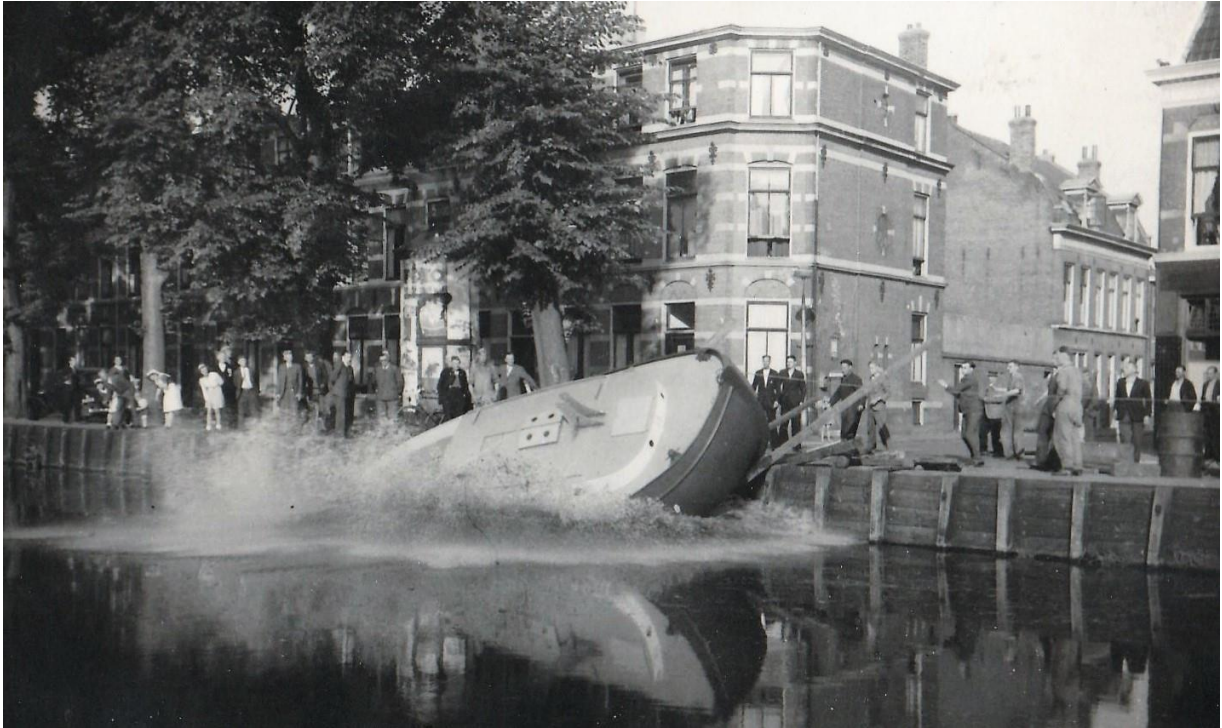
Haarlem, 1949. Traditioneel met behulp van twee balken ter geleiding. Op de amateurfilm van deze tewaterlating (die bij de SSRP info over de Bram te zien is) zie je de kont te vroeg wegglijden, maar de jol volgde probleemloos.
