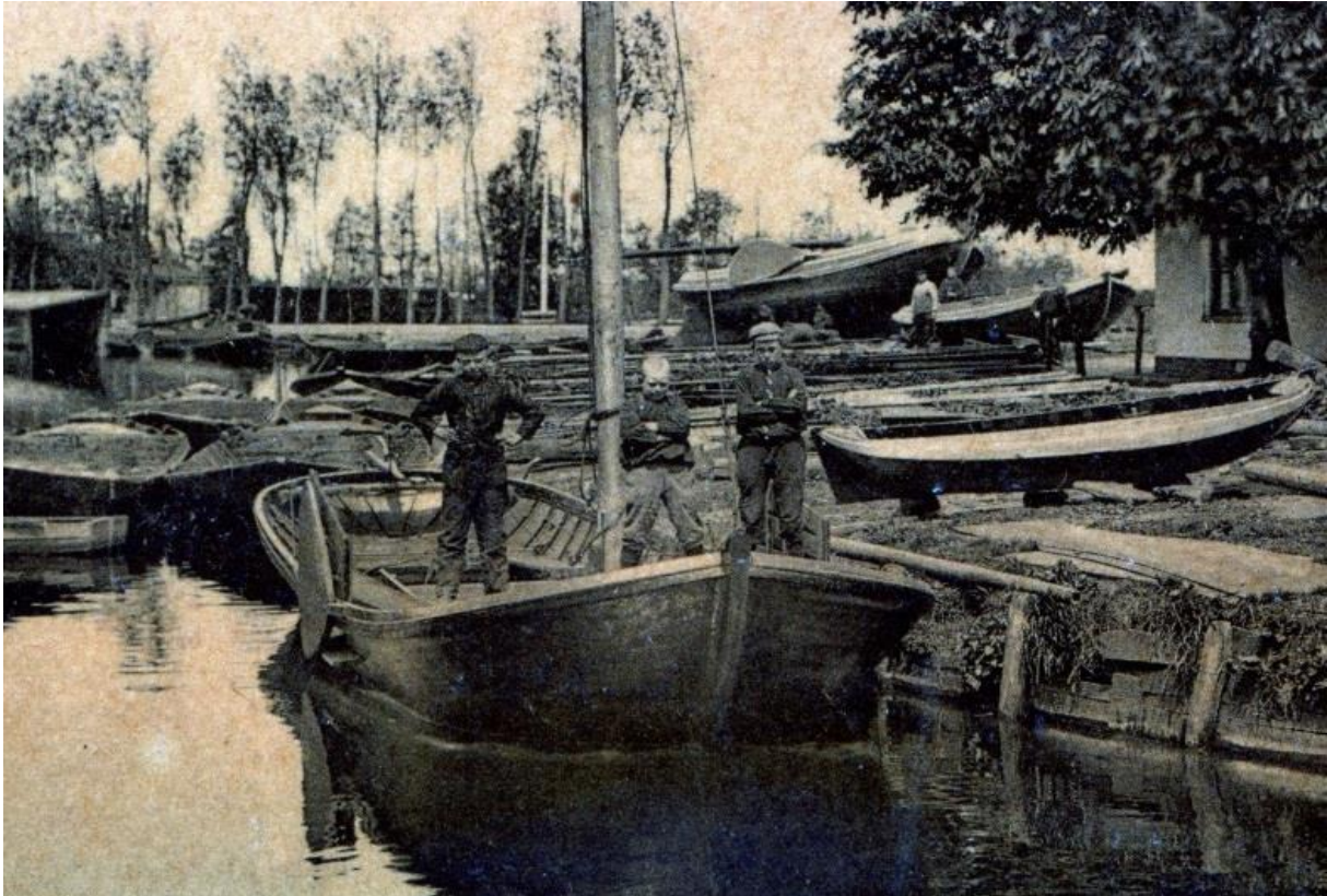
Joure, begin 1900. Een ijzeren praam van ruim 11 meter voor de werf van Auke van der Zee, die dit scheepje bouwde in de winter 1903-1904. Opvallend is de vorm die afwijkt van de gebruikelijke ronde ijzeren pramen. Het is qua vormgeving een kopie van een houten Friese praam, zo wordt op de tekening vermeld. Deze praam heeft meer van de Berlikumer pramen. (Foto: FSM)
