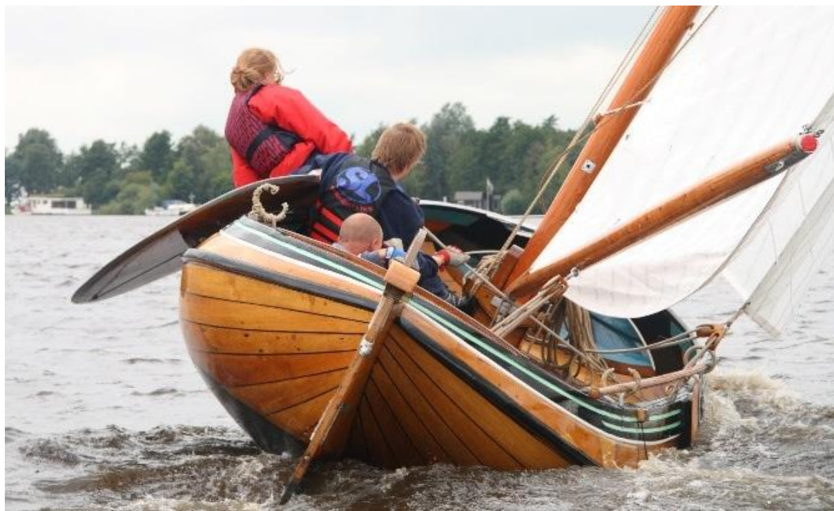
De Wäldfögel zeilend op de Wijde Ee bij de Veenhoop in 2010. Goed te zien is, dat deze ronde jachten geen wanten ('zijstagen') voeren, wat het strijken en zetten van de mast sterke vereenvoudigt. Roer: K.M. Elema met dochter Paulien en haar man Jan Hendrik aan de fok.
