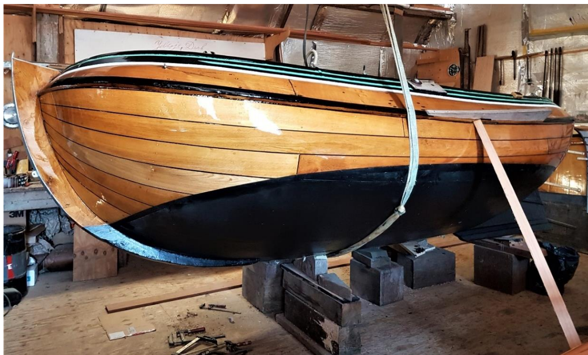
Workum, juni 2020. De nieuw aangebrachte gang is goed herkenbaar in het voorschip. (Foto: Dirk Huizinga)
