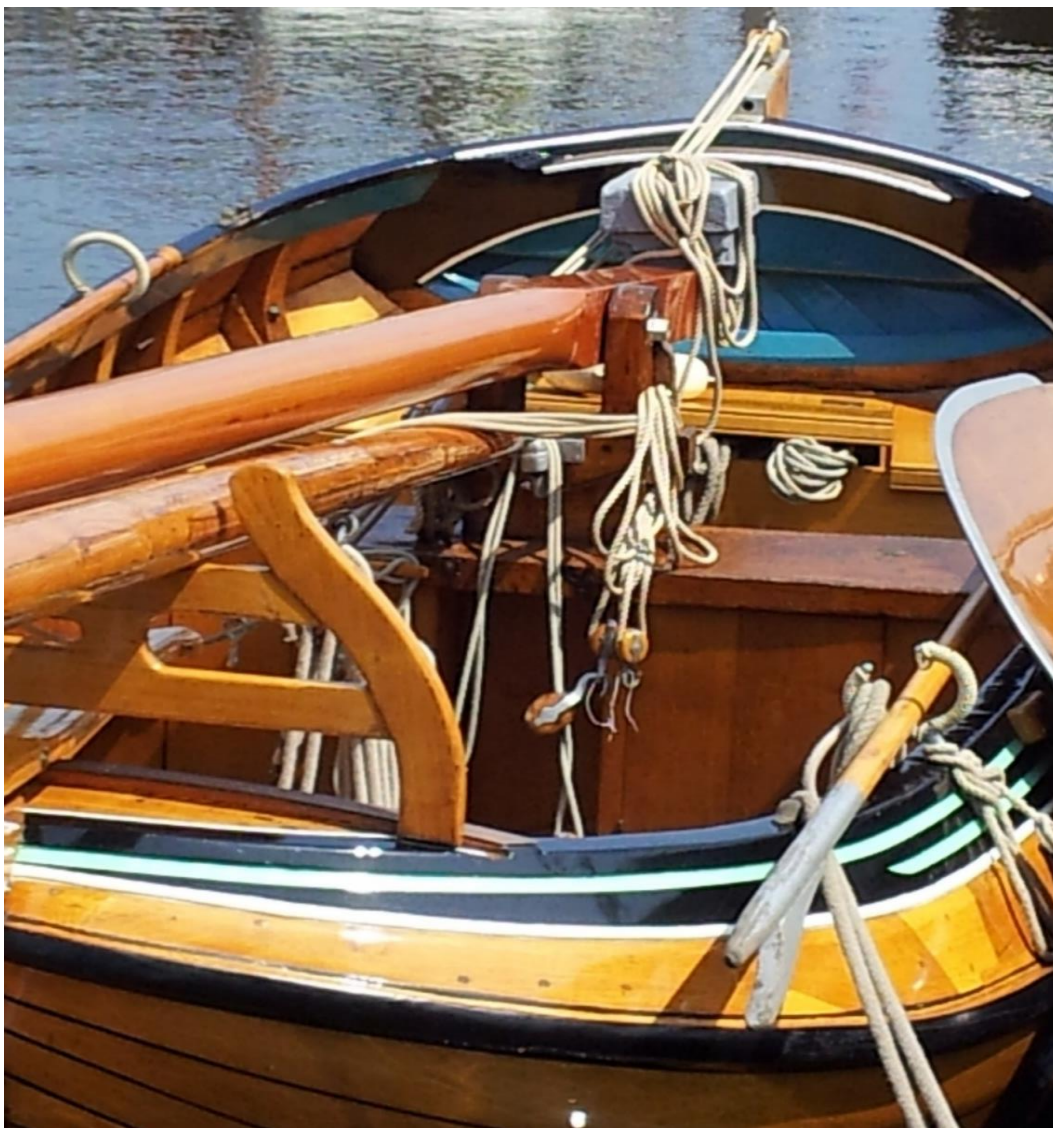
De Wäldfûgel met gestreken mast, met aan de mastvoet een loden contragewicht, in 2017
