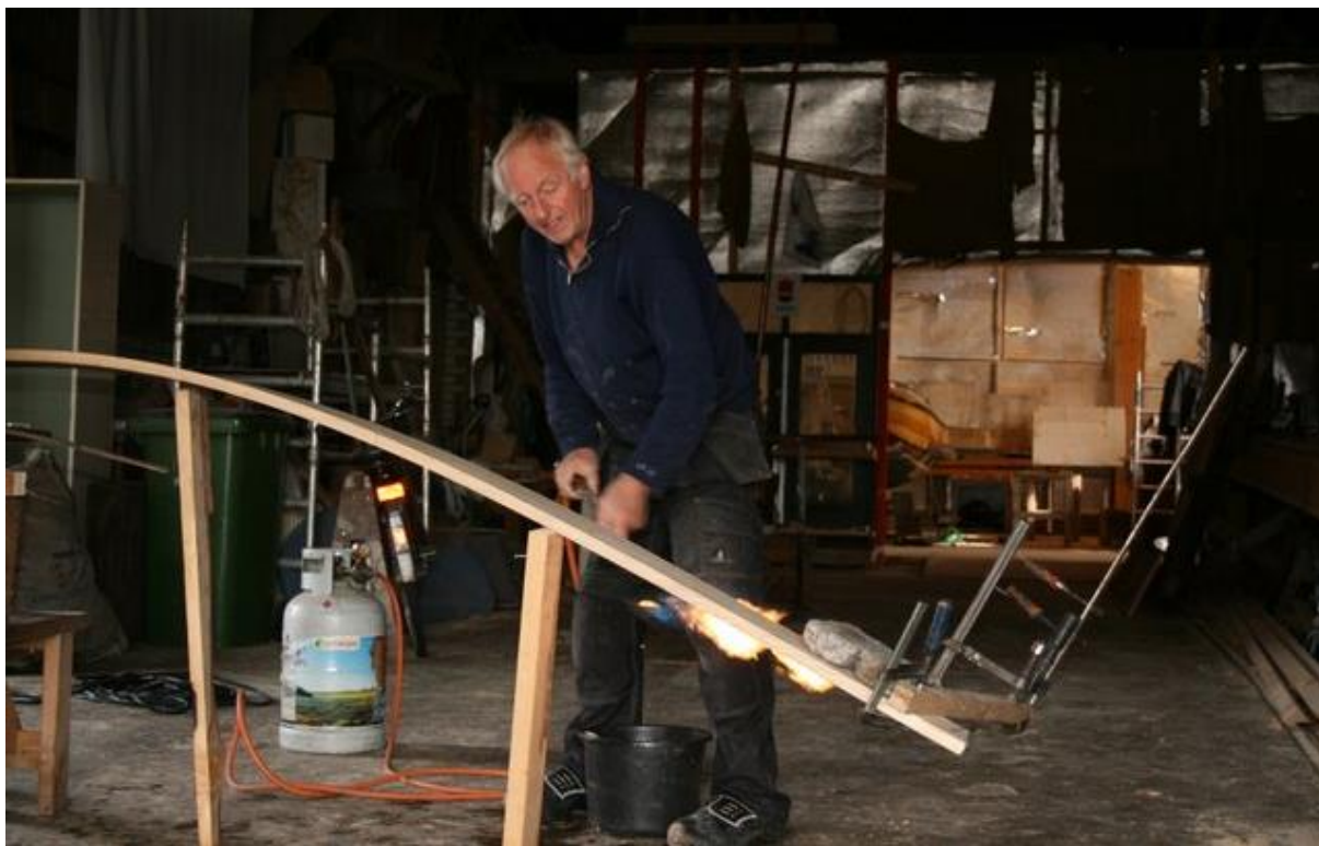
Workum, Roelof van der Werff bezig met het branden en daarmee buigen van een eiken gang.
