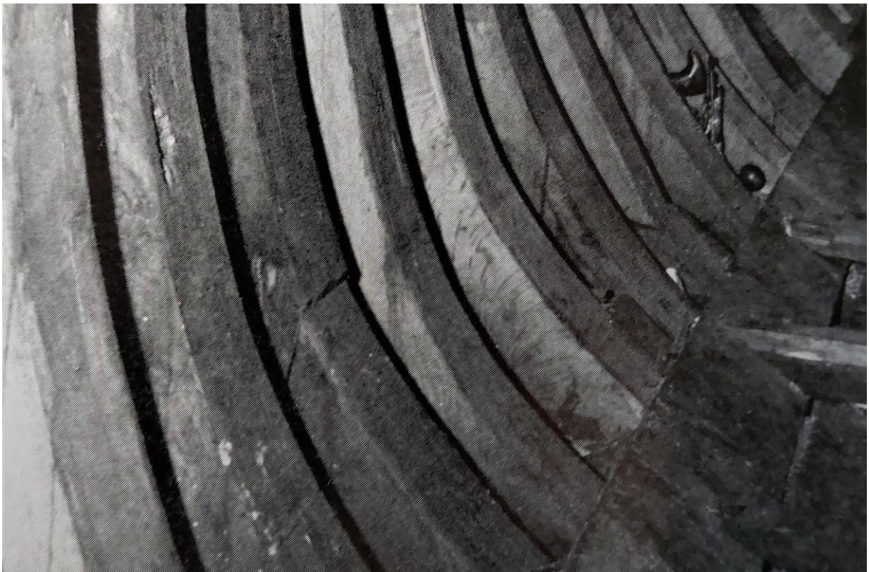
Doorlopende inbouten (met schuine lassen) bij de boeier Friso', in 1894 gebouwd in Joure.
