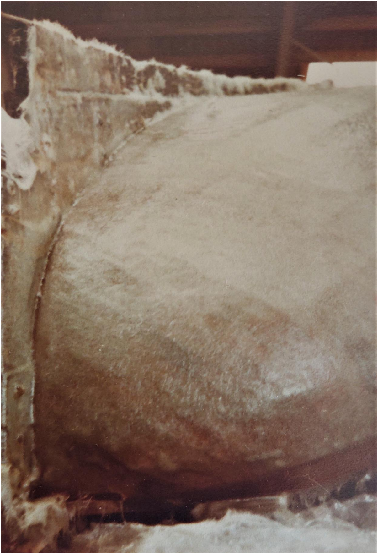
Ook na het harsen is te zien dat de kielbalk niet meer recht loopt.
