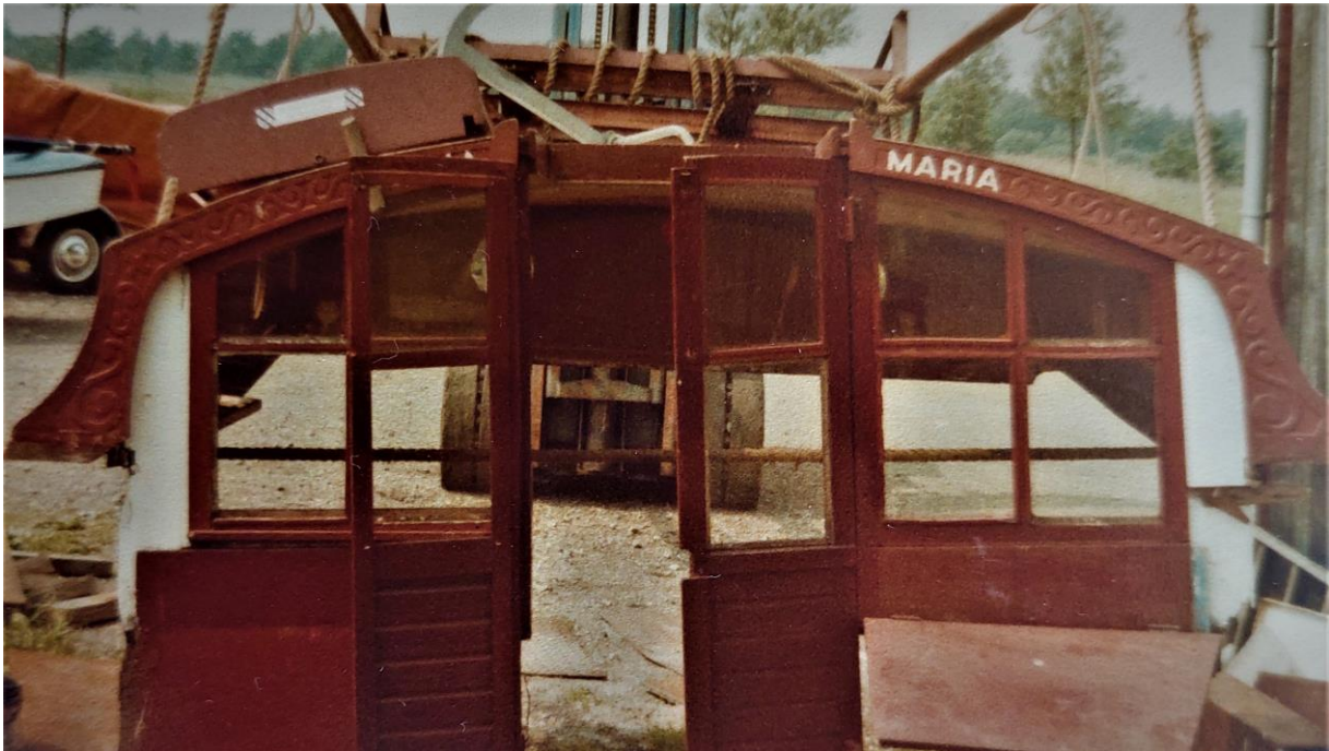
De kajuit die Gabriel Bolier aanbracht is voor het inharsen verwijderd. Daarna is een nieuwe roef aangebracht, voorzien van de oude versierde kajuitlijst.
