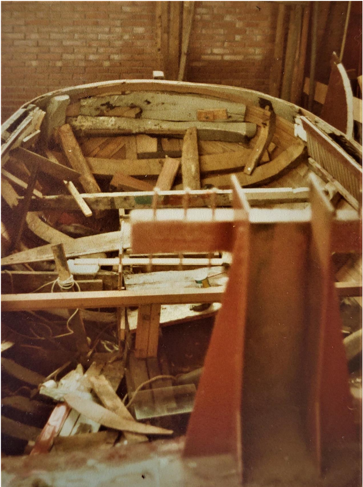
Een groot deel van de oude huis en de inhouten wordt gesloopt en vervangen door enkele nieuwe inhouten, terwijl met stroken dun hecht hout een ondergrond wordt gemaakt voor het bekleden van de huis met glasvezelmatten en polyesterbars.
