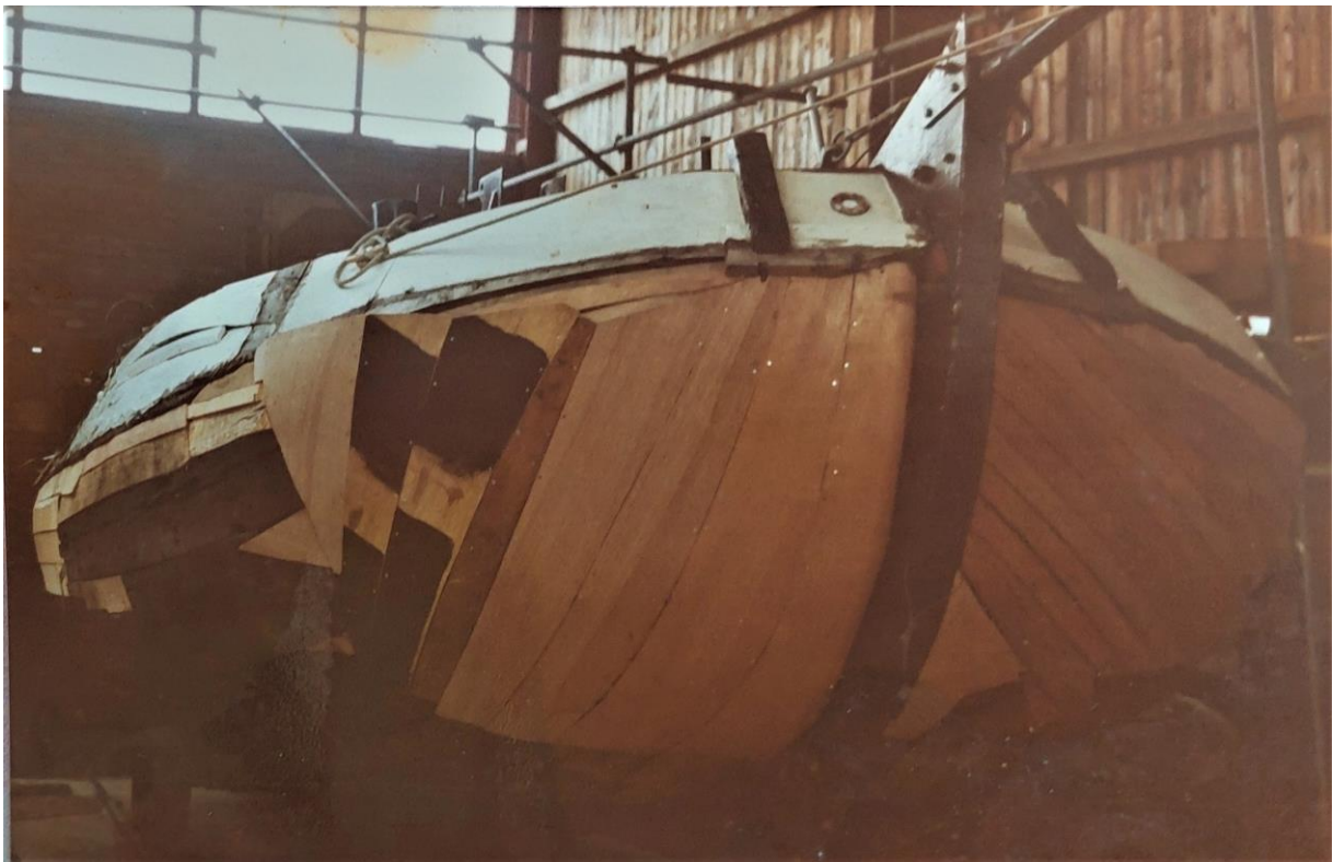
Door de sloop van het stort en de oude gangen met inbouden werd het nodig met behulp van enige nieuwe spanten en stroken bechthout de oude vorm te herstellen
