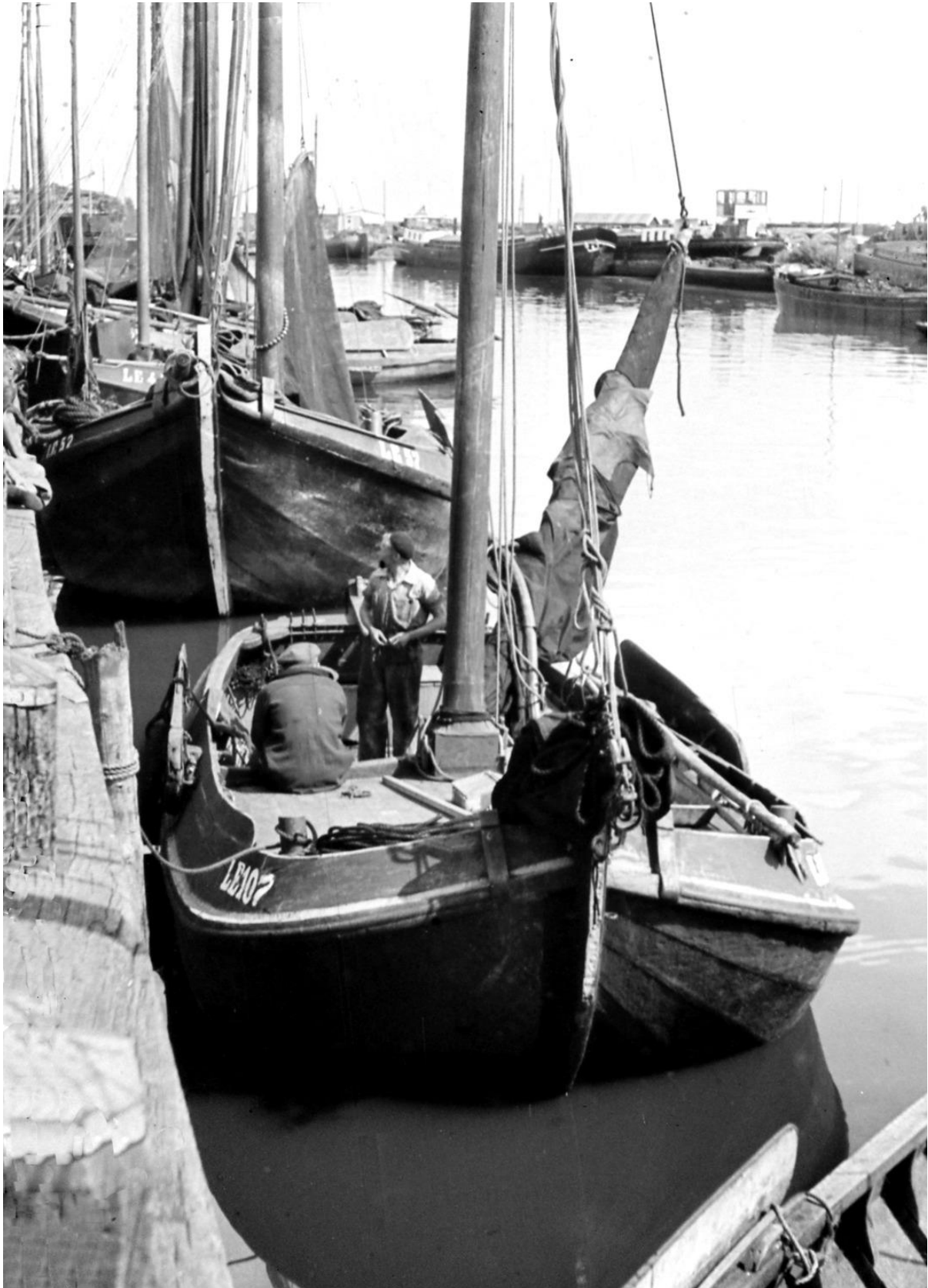
De Lemmer, 1950. De visaak LE 107 met rechts Gauke en links Jurjen Bootsma, de eigenaar en vergunninghouder van de visaak. De romp onder het berghout zit op de foto in het stort. De houten bolders links en rechts op het voordek zijn vervangen door stalen exemplaren.
