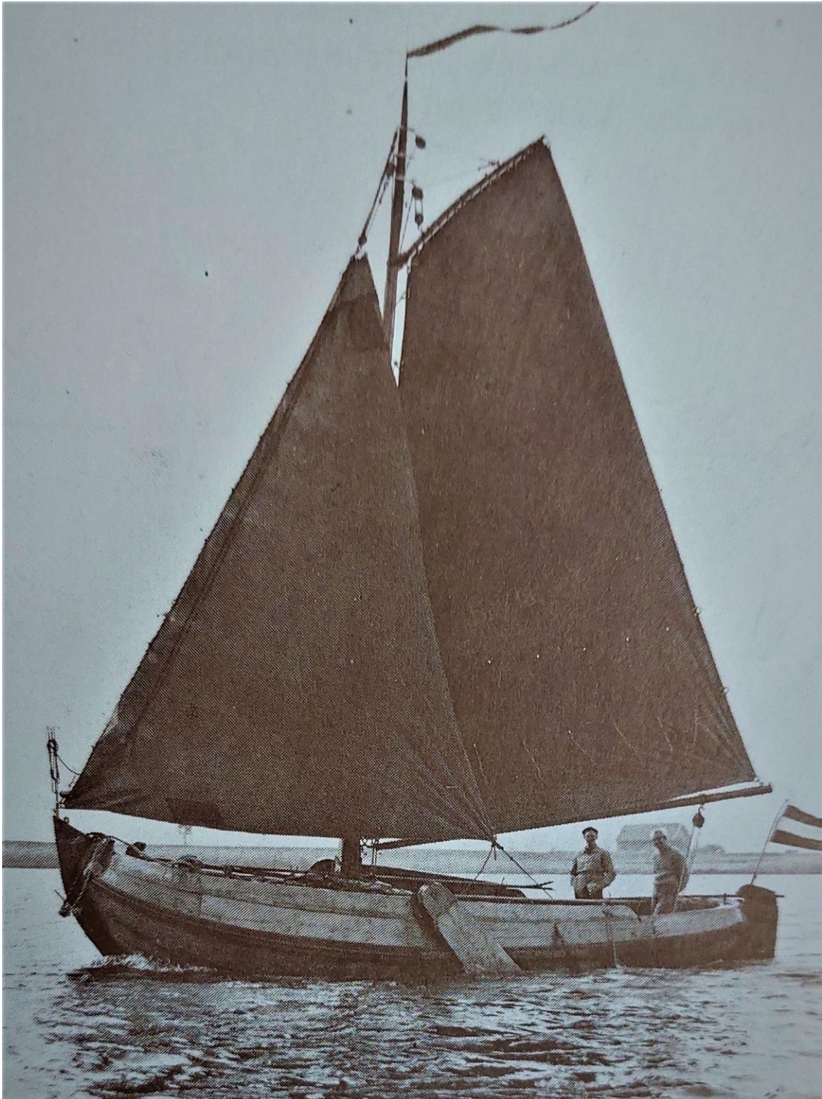
De grote Enkhuizer aalboot 'Lydia' als jacht (met vlag). Oorspronkelijk de BIW 18 (Broek in Waterland). Een flink en slank schip voor een aalbootje! Opvallend zijn ook het ontbreken van een korte botteloef en de smalle zwaarden. De foto is gemaakt nadat deze bol over is gegaan naar de recreatie. (Foto uit: Martens/Westra, 1988. p. 68)
